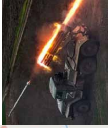
Raketenwerfer Grad (russ. Hagel), Reichweite 50 km
